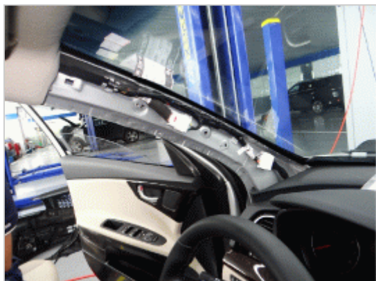
14. 使用夹拆卸工具, 分离车顶装饰板总成固定夹(A)。
